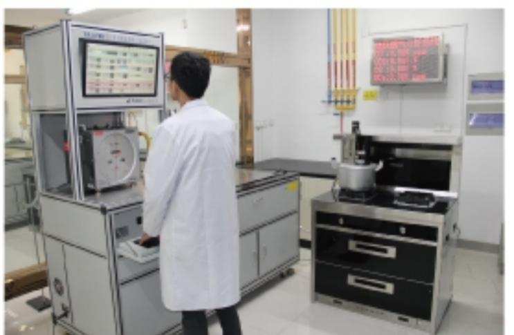
性能等20多个关键的严格考验。例如，为了让集成灶在气候恶劣地区能照常使用，产品要在85℃高温、85%湿度的环境中接受可靠性检测，各种元器件在高低温和湿热环境下性能指标合格，产品才能出厂。
